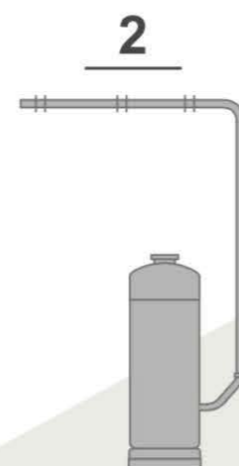
TUBAZIONE METALLICA Serie media Ø 1' per tutta la lunghezza per la distribuzione della polvere
